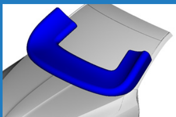
Nově navržený tvar Airbagu (zvýšený profil)
