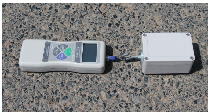
Měřicí zařízení ke zjišťování podélného koeficientu tření povrchu vozovek
