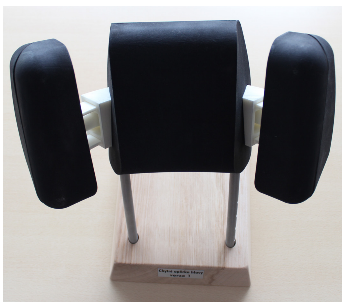
model aktivní opěrky z 3D tiskárny
