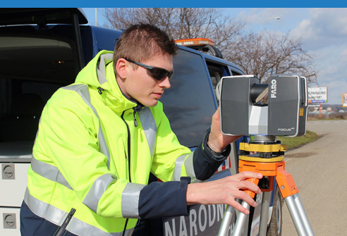
skenování deformací vozidla pomocí 3D skeneru
